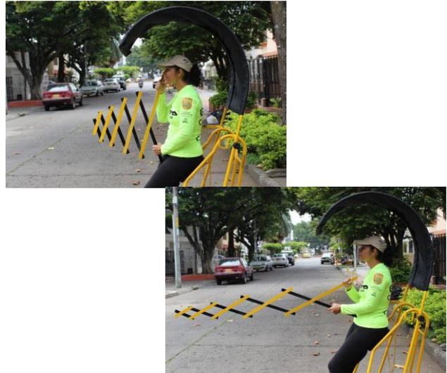
Fig. 3. Elemento para regular el paso.
