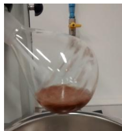
Fig. 3. Semillas de guayaba sumergidas en ácido sulfúrico.
